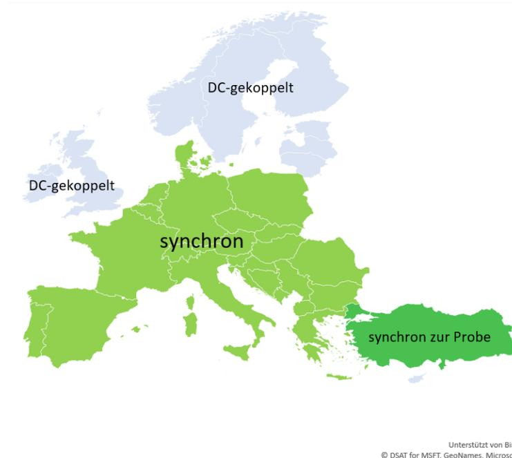
Abbildung 1: Mitglieder des Verbands der Netzbetreiber (ENTSO) mit Unterscheidung der direkt gekoppelten Regionen (europäisches Verbundnetz, synchron) sowie der mit Gleichstrom-Verbindungen (DC) an das Netz angeschlossenen Regionen
